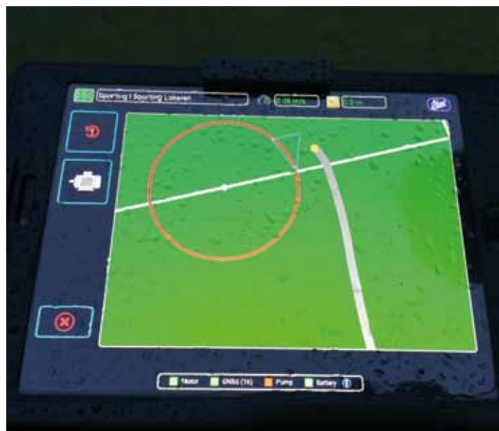
De display van de maqa waar je exact het veld kunt zien en wat je moet belijnen.
